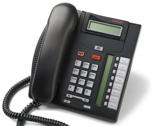
Телефон T7208 входит в семейство терминалов бизнес-серии (Business Series Terminal). Телефон оснащен восьмью полностью программируемыми кнопками, каждая из которых содержит собственный СИД, и буквенно-цифровым дисплеем на 1 x 16 символов для отображения информации о ходе выполнения вызова. В модели T7208 нет экранных кнопок (программных ключей).
