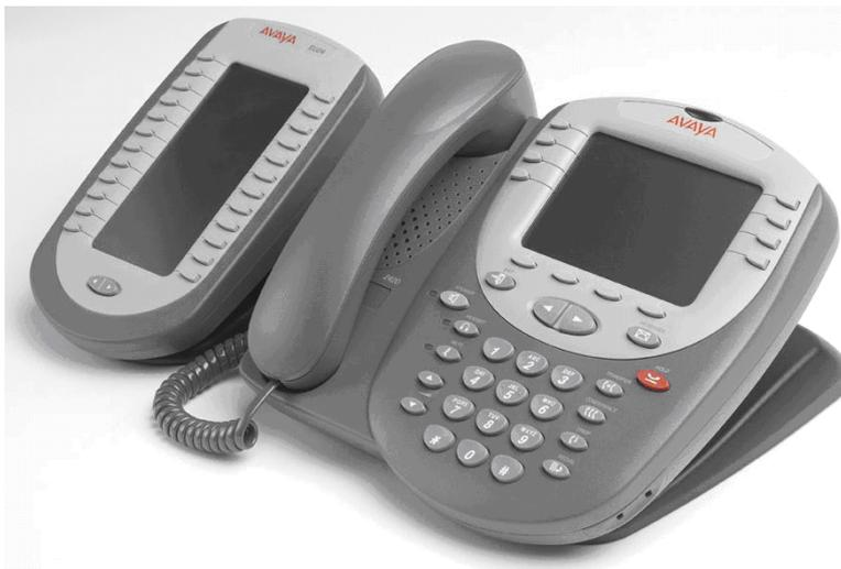
EU24/EU24BL — это телефонные модули расширения, которые работают в сочетании с телефонами 5420, 5620/1, 2420, 4620/1, 4625. Они обеспечивают наличие 24 дополнительных программируемых кнопок, связанных с метками дисплея и значками статуса. К одному телефону можно подключить только один модуль EU24. Модуль EU24BL оснащен задней подсветкой и предназначен для использования только с телефонами 4621 и 5621.
