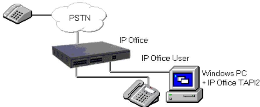
Microsoft TAPI 2.1 и 3.0 — это спецификации и интерфейсы разработчиков, предназначенные для управления и мониторинга телефонного устройства. Спецификация содержит требования относительно внедрения определенной базовой функциональности и дополнительно определяет набор опциональных функций, которые поставщики коммутаторов также могут внедрить в свои устройства.
