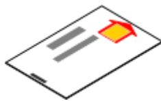
Этот тип ключа функций используется с управляющими устройствами IP500 и является обязательным. Управляющее устройство должно быть оснащено одним из таких ключей функций даже в тех случаях, когда не используются никакие лицензии.
