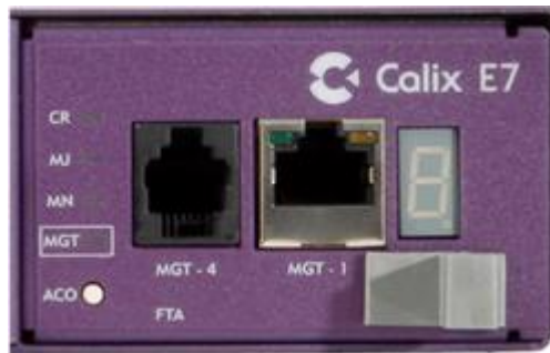
Calix E7-2 Fan Tray Assembly Front Panel
