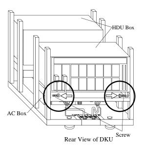
Fig. FT6-10 Attachment the Plate
