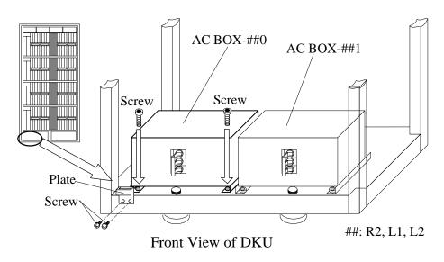
Fig. T18-6 Attachment of AC BOX
