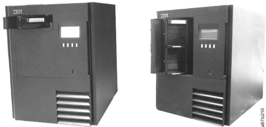
Abbildung 6. Typen von E/A-Stationen im Kassettenarchiv. Die E/A-Station für ein einzelnes Fach ist links und die E/A-Station für 12 Fächer rechts abgebildet.
