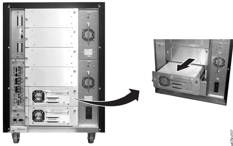
Abbildung 8. Bandlaufwerk im Kassettenarchiv. Das Bandlaufwerk befindet sich in einem austauschbaren Laufwerkschlitten. Diese Ansicht ist eine Rückansicht des Kassettenarchivs.
