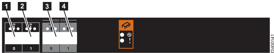
図 23. 拡張エンクロージャ・プロセッサ・カードのポート位置コード
