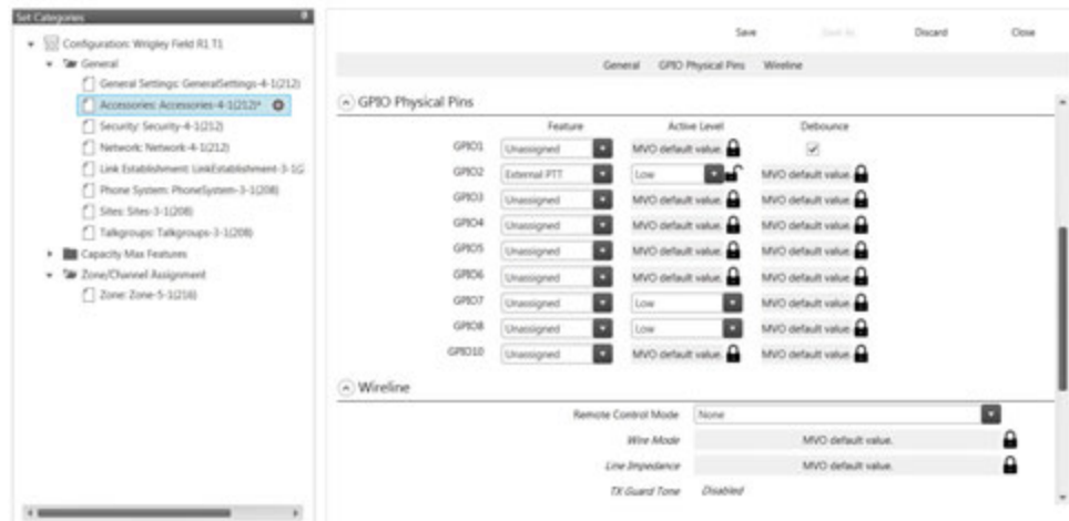
Figure 47: Configuration de la Gestion radio pour l'adaptateur de tonalité à distance L3276 (pour une télécommande à 2 canaux)
