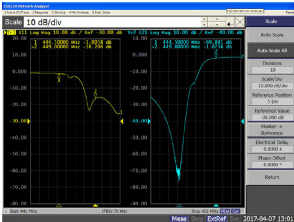
Figure 24: Réglage du port HAUT du duplexeur
