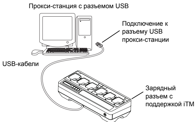
Рис. 28. Подключения радиостанций к iTM-прокси с помощью многоместного зарядного устройства
