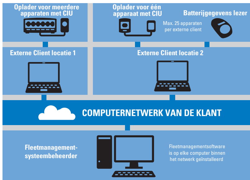
Afbeelding 19: IMPRES-batterijmanagement via netwerkopladers
