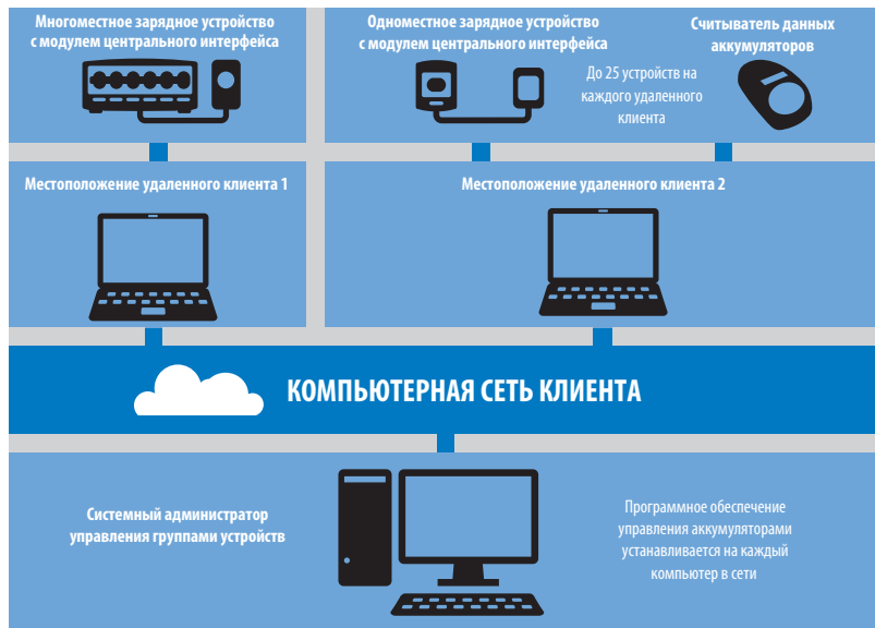
Рис. 19. Управление аккумуляторами IMPRES через сетевые зарядные устройства
