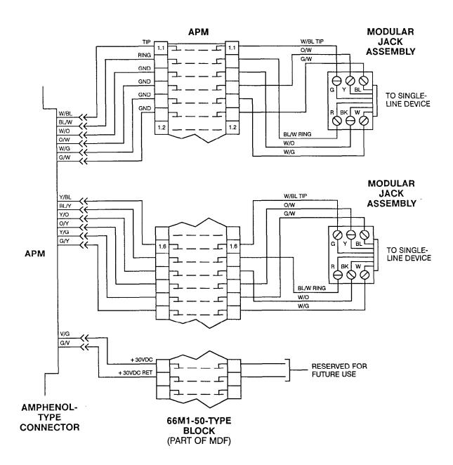
FIGURE 3-5. STANDARD STATION CABLE TERMINATIONS ON THE STATION BLOCK
