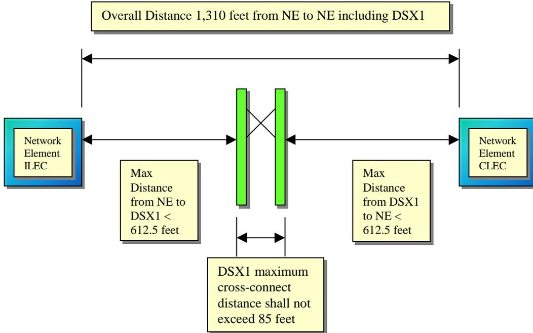
**DS1/T1 using 24 gauge twisted pair cable**
