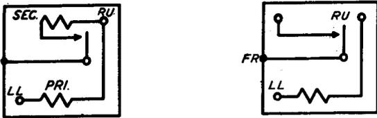
FIG. 32 - WINDING TERMINAL ARRANGEMENT AS VIEWED FROM THE REAR (TERMINAL SIDE) - 5 TYPE MESSAGE REGISTERS
