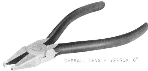
Fig. 14—KS-16735 Contact Cutting Pliers
