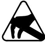
**ACHTUNG****Geräteschäden durch elektrostatische Entladung**
