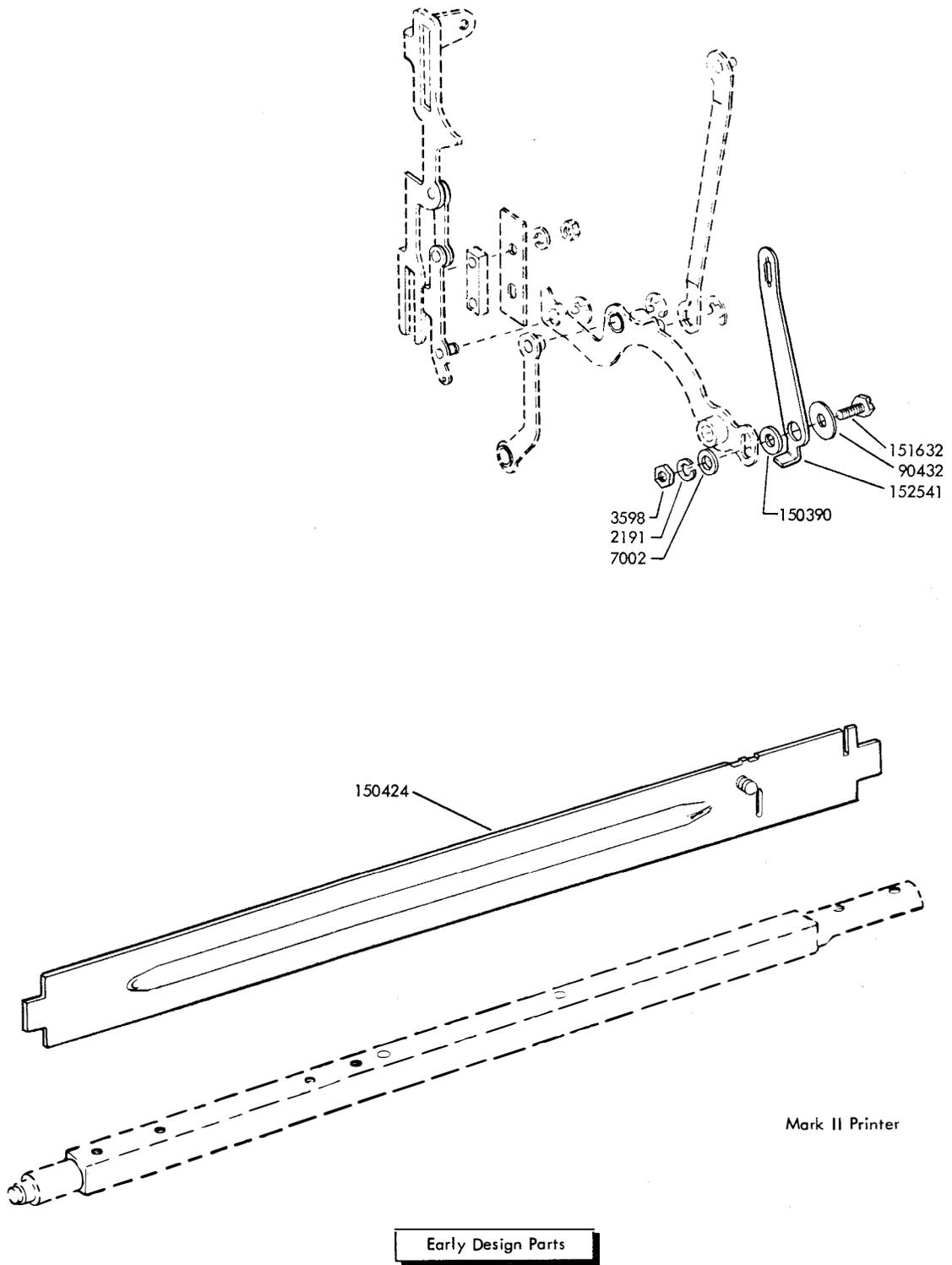
FIGURE 20. LEFT SIDE LINKAGE AND STRIPPER BLADE MECHANISM
