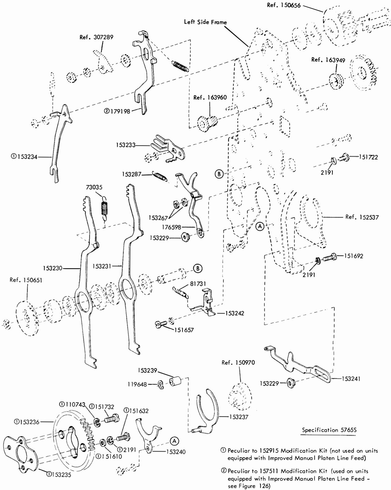
FIGURE 85. 152915 AND 157511 MODIFICATION KITS TO PROVIDE LOCAL REVERSE LINE FEED
