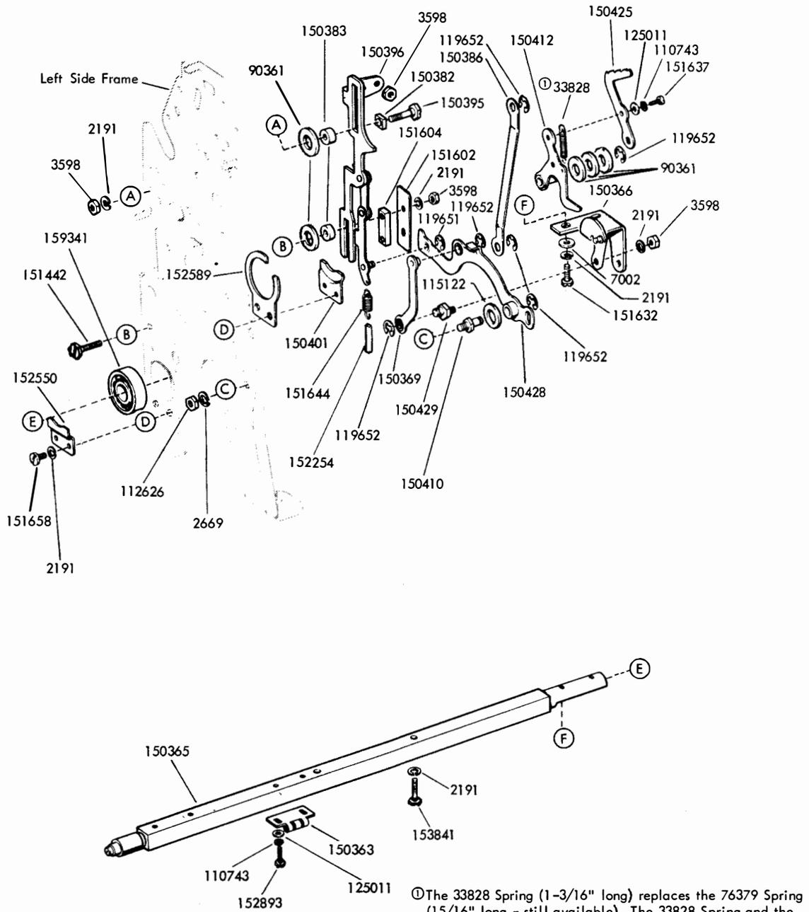
FIGURE 19. LEFT SIDE LINKAGE AND ROCKER SHAFT MECHANISM
