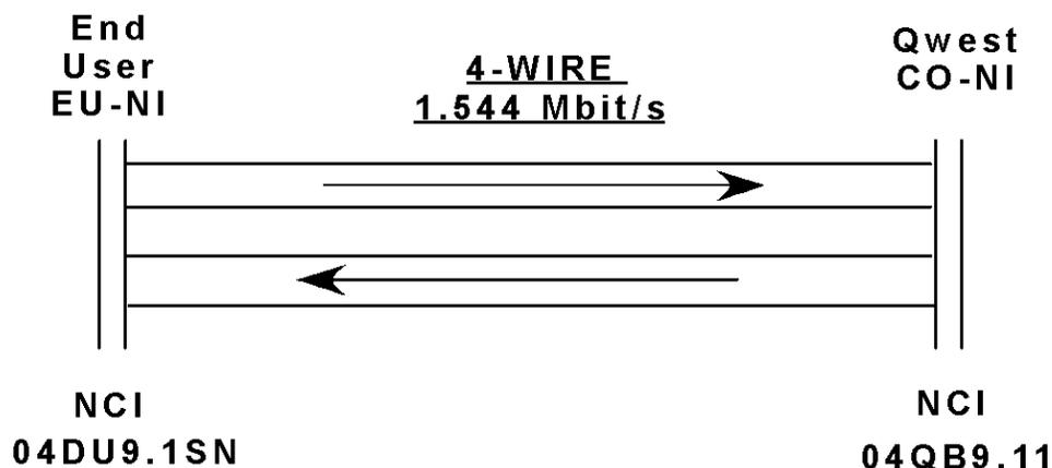
Figure 5-4: Typical DS1 Unbundled Channel.
