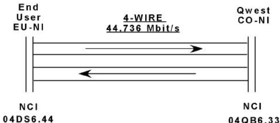
**Figure 5-5:** Typical DS3 Unbundled Channel.
