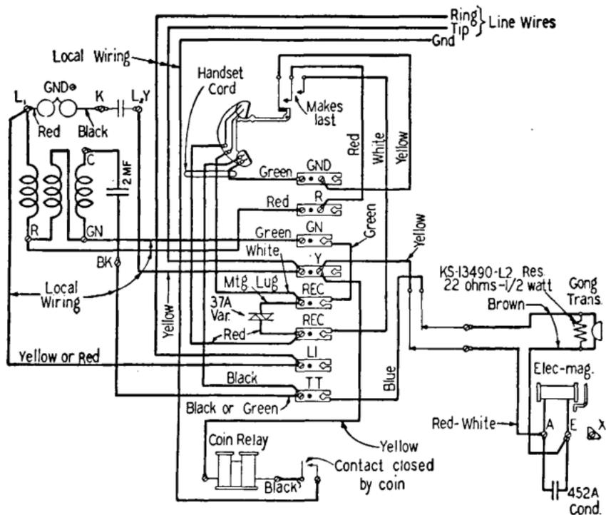
Fig. 3—74AC Coin Collector
