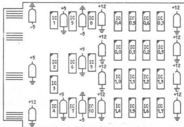
UNMARKED COMPONENTS ARE FILTER CAPACITORS.
