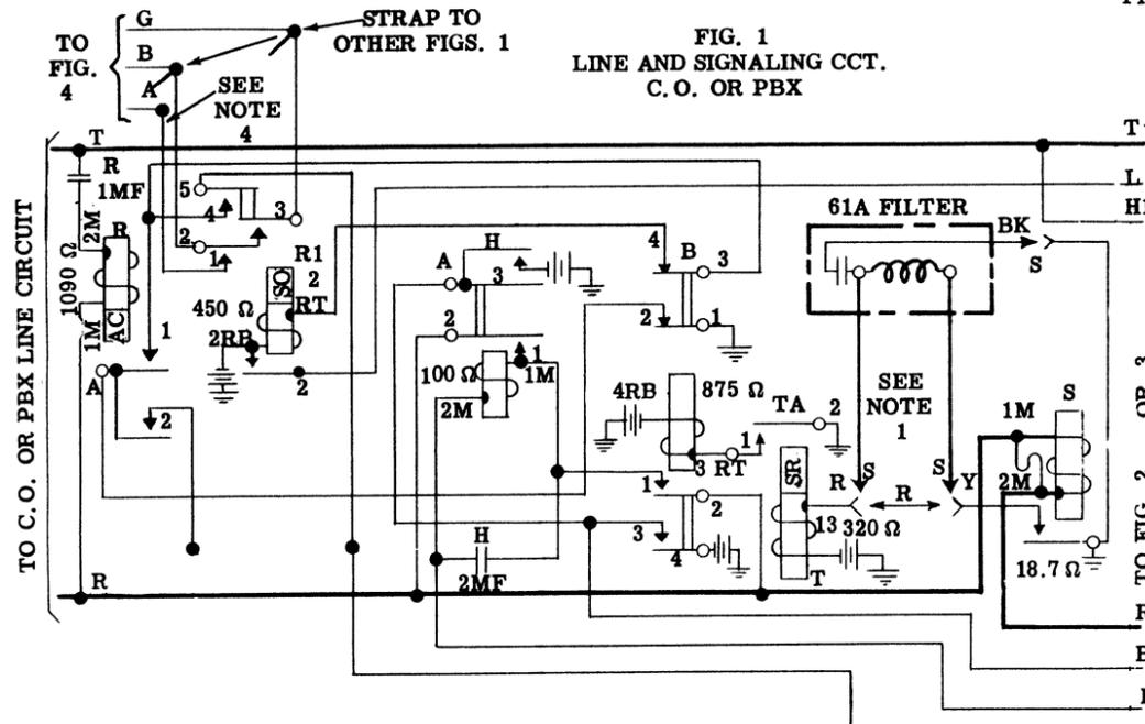
COMMON BUZZER CIRCUIT
