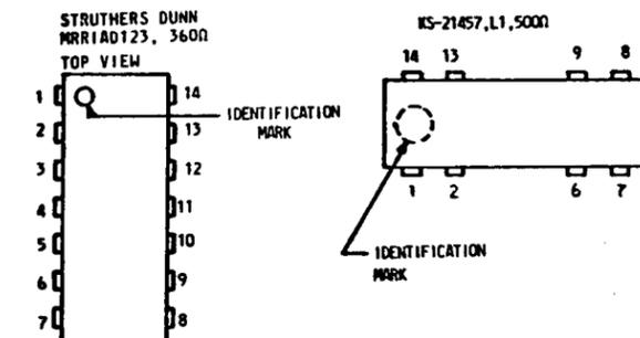
311. THE TERMINAL ARRANGEMENT OF THE 1301 TYPE INDUCTOR IS:
