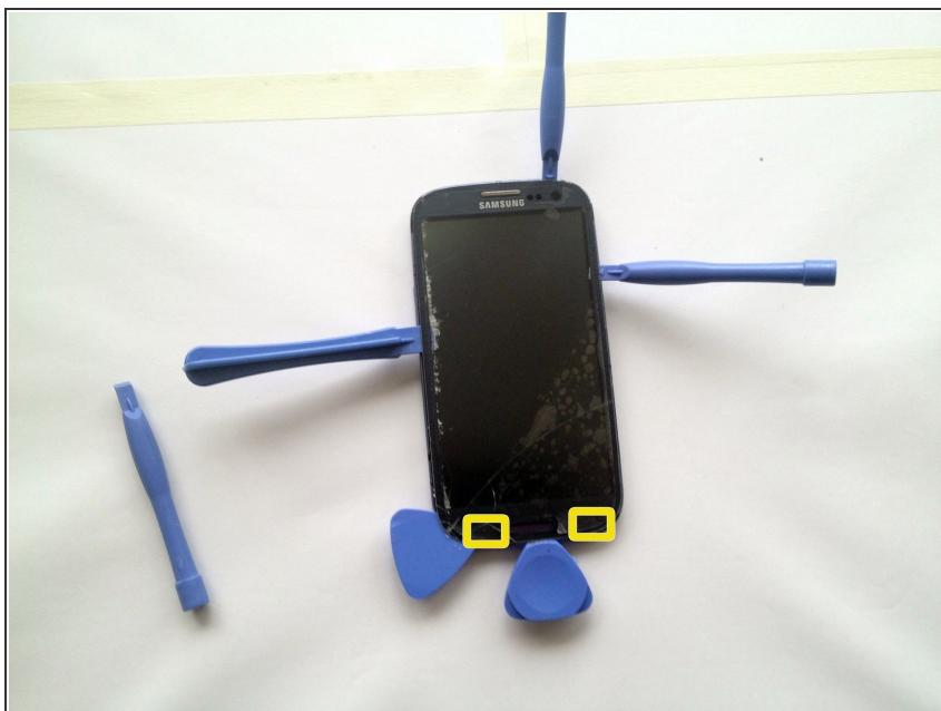
! Вы должны начать отделять стекло *от верхнего края, постепенно двигаясь к центру, отклеивая весь экран* сверху вниз. Оставьте некоторые инструменты между стеклом и корпусом для предотвращения приклеивания стекла обратно.
